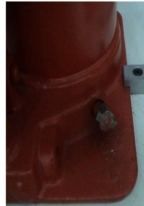
圖 5. 使用加壓扳手的凹槽 將閥洩壓
